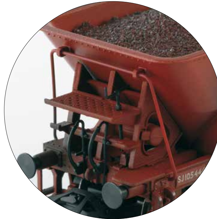
Tutti i carri con piattaforma del frenatore e manovella del freno
