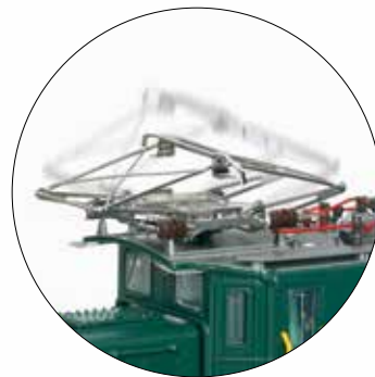
Presa di corrente a pantografo con strisciante più largo
