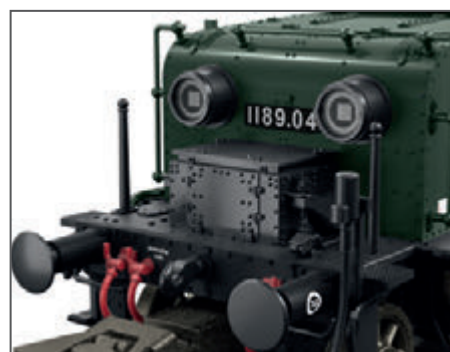
Frontale della locomotiva: fanali prominenti e sul frontale la cassetta tipica per la locomotiva
