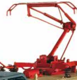
Pantografo di nuova progettazione del tipo SBS 65
