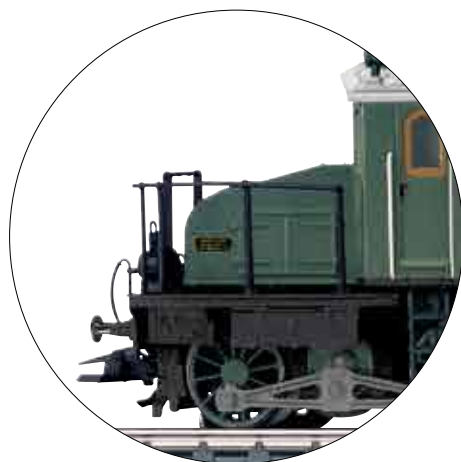
Trasmissione fedele al prototipo mediante asse cieco
