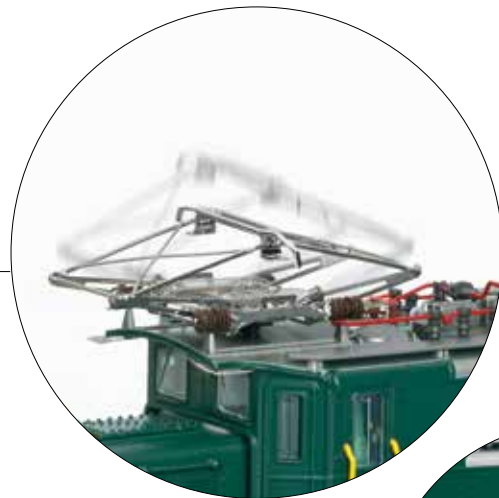
Fedele al prototipo con radiatori dell'olio su entrambi i lati
