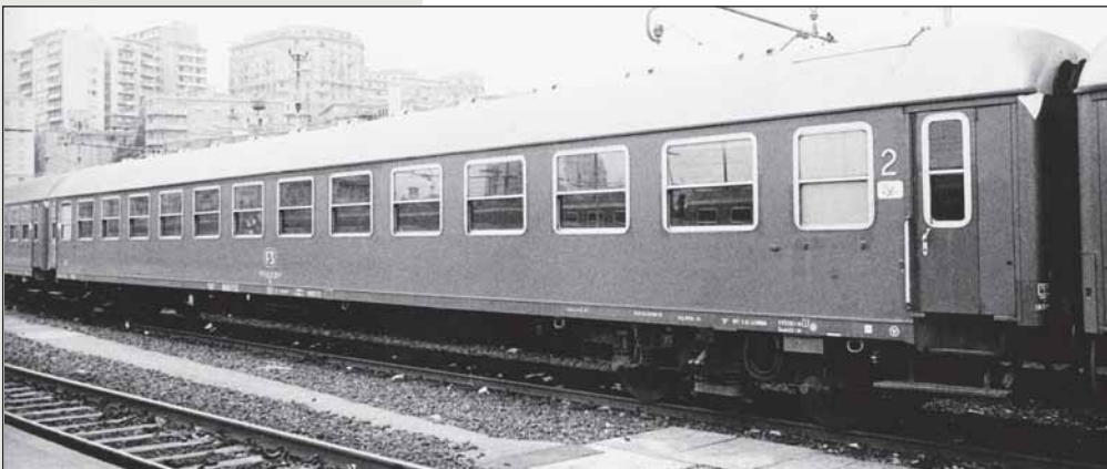
Carrozza FS di seconda classe Tipo X 1968, livrea grigio ardesia e carrelli Minden FD. Epoca IV. Second class UIC-X 1968 type car of Italian Railways in slate gray livery and MD brake disc bogies. Epoche IV. 2er Klasse Typ UIC-X 1968 Wagen der Italienschen Eisenbahnen in schiefergrauer Lackierung mit MD Drehgestellen. Epoche IV.
