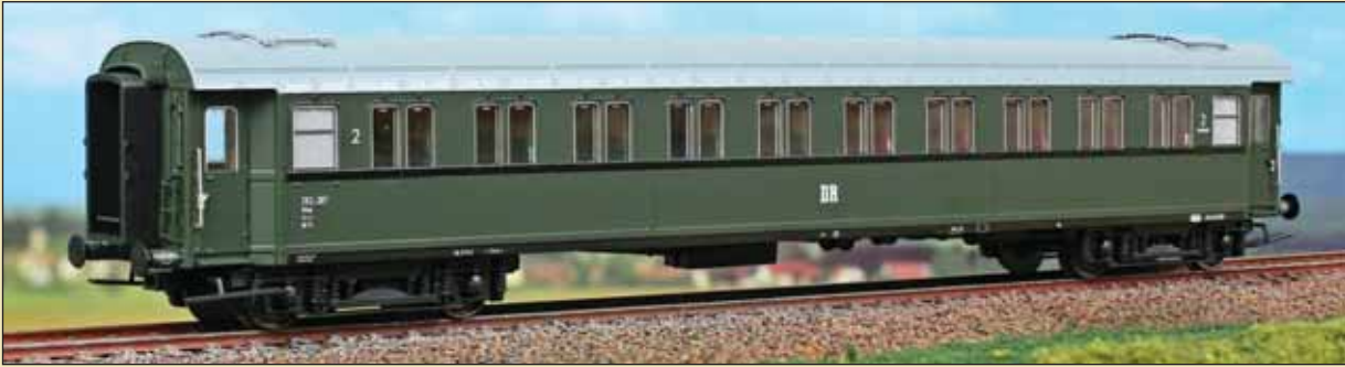
Carrozza di 2 a classe BüP 203-307, ex Cz 32000 FS, nella livrea verde delle DR. Carrelli Görlitz III. 2 nd class DR car BüP 203-307, based on italian Cz 32000 car. Green DR livery, Type Görlitz III bogies. 2. Klasse Wagen BüP 203-307 der DR, auf einem italienischen Cz 32000 basierend. Grüne DR Lackierung, Görlitz III Drehgestelle.
