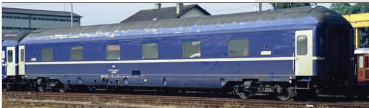
Carrozza letti WLABmz con carrelli München-Kassel, livrea blu con fasce e porte bianche. Sleeping car WLABmz with München-Kassel bogies, blu livery with white stripe on sides and white doors. Schlafwagen WLABmz mit München-Kassel-Drehgestellen, blaue Livree mit weißen Bändern und Türen.
