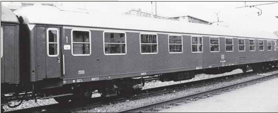
Carrozza FS di prima classe Tipo UIC-X 1968, livrea grigio ardesia e carrelli Minden FD. Epoca IV. First class UIC-X 1968 type car of Italian Railways in slate gray livery and MD brake disc bogies. Epoche IV. 1er Klasse Typ UIC-X 1968 Wagen der Italienschen Eisenbahnen in schiefergrauer Lackierung mit MD Drehgestellen. Ep. IV.
