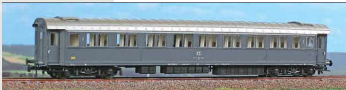
Carrozza di 1ª classe serie Az 52000 nella livrea grigio ardesia degli anni '70 con marcatura UIC, equipaggiamento elettrico per servizio internazionale e porte risanate. Carrelli FS 31. 1st class Type 1937 (Az 52000) car of the FS with electric equipment for national and international services, with refurbished doors. Type FS 31 bogies, slate gray livery. 1. Klasse Wagen Typ 1937 der FS, schiefergraue Lackierung, erneuerte Türen, Typ 31 Drehgestelle, mehrspannungsfähig, auch für internationale Dienste.
