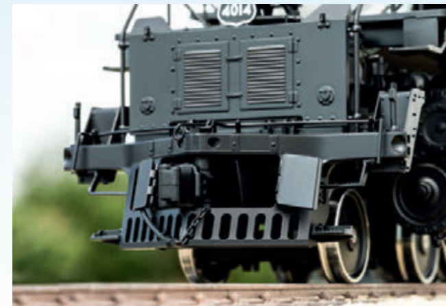
Il gancio frontale è nascosto con raffinatezza dietro due portelli nello spazzaneve
