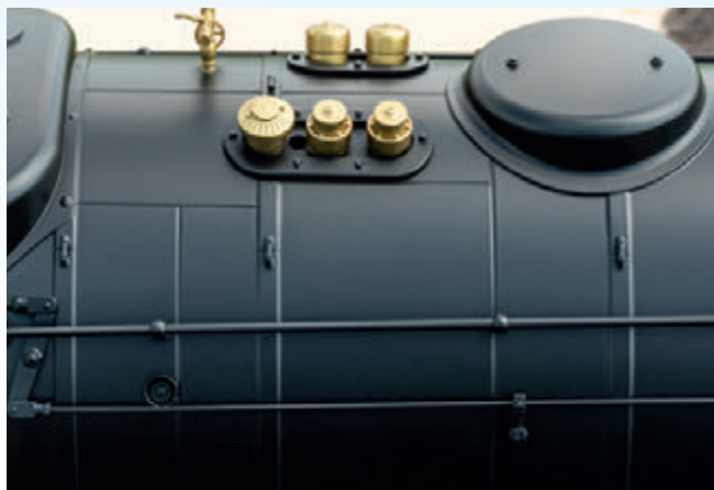
Le valvole di sicurezza nel caso del modello – in modo corrispondente al prototipo – sono state realizzate di ottone
