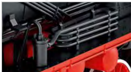
Essiccatore d'aria elaborato con separatore d'olio
