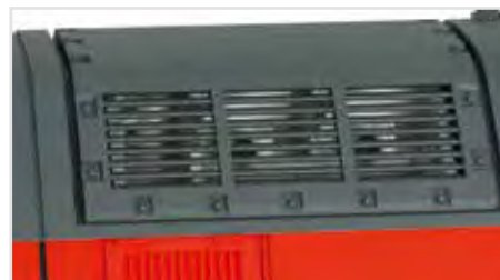
Griglie ventilazione perforate con aria condizionata e compressore dietro di essa
