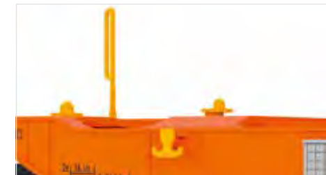
Ganci ancoraggio per fune applicati separatamente
