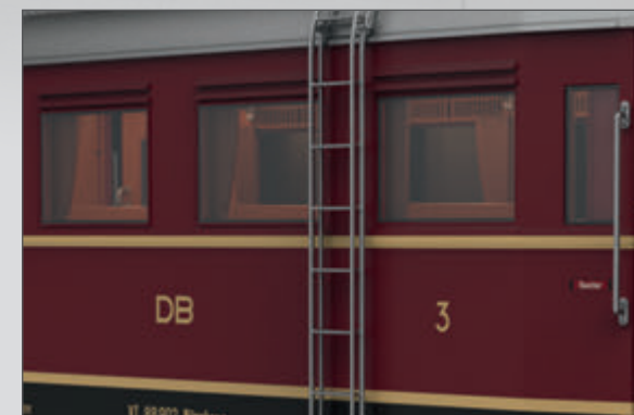
Scaletta di accesso alle strutture del tetto
