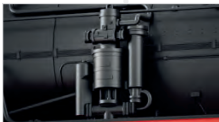
Pompa di alimentazione tipo Knorr KT1-250 con controllo Tolkien
