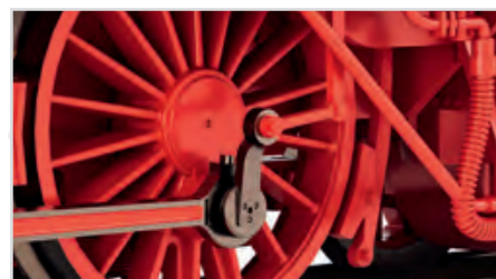
Azionamento mobile della pompa di lubrificazione
