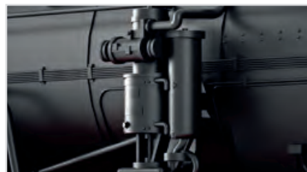
Pompa di alimentazione tipo VEB BBW KP4-250 con controllo Peters
