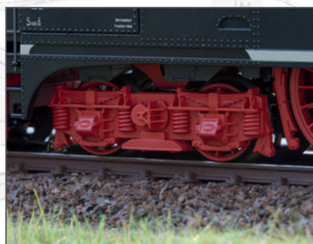
Magnete Indusi dal lato destro della locomotiva sul carrello posteriore
